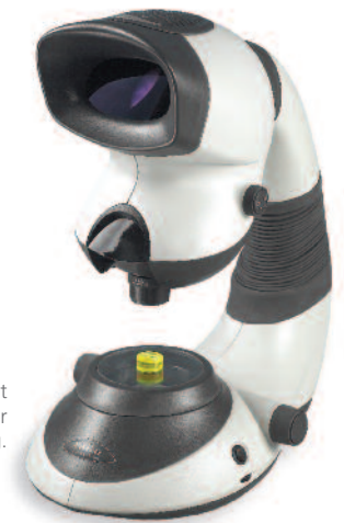
Tischstativ. Stabiler robuster Tischstander mit integrierter Fokussierung, dimmbarer Durchlicht-Beleuchtung.
